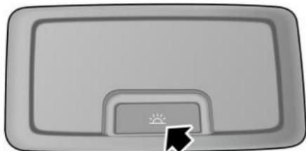
Pulse el interruptor (en forma de flecha) para iluminar las ventanas traseras y vuelva a pulsarlo para apagarlas.
