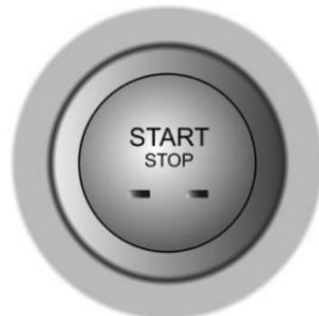
El interruptor START/STOP sin llave está situado en el panel embellecedor de la consola central y pertenece al interruptor de arranque por botón. Para accionar el sistema, la llave inteligente debe estar en el automóvil.
