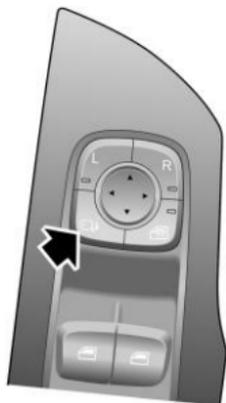
Pulse el botón (como indica la flecha) del interruptor combinado situado en el lado del conductor y el retrovisor exterior se plegará eléctricamente. Si vuelve a pulsar el botón, los retrovisores volverán a su posición original.
